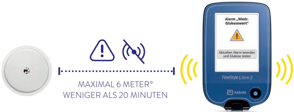
Ihr Lesegerät kann die Glukose-Alarme<sup>1</sup> aus bis zu 6 Metern Entfernung empfangen<sup>o</sup>. Alarme werden nur an das erstverbundene Gerät übermittelt. Wenn Sie die Alarme nutzen möchten, folgen Sie bitte der Anleitung im Benutzerhandbuch.
